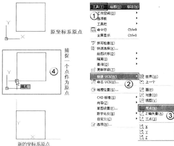
图 1-10 通过菜单命令定义新的用户坐标系原点
