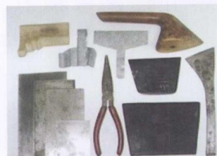
彩图3-2-1 地仗施工常用铁板、铲刀、皮子、麻轧子、轧子
