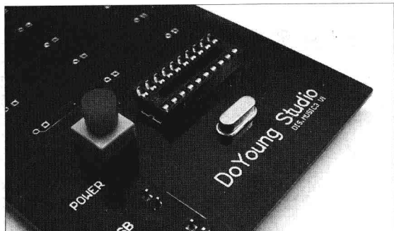
焊接芯片座、石英晶体和电源开关
