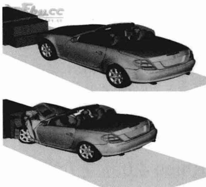
图1-19 虚拟现实环境下的汽车撞击试验
