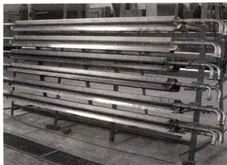
圆网印花机一体化的给浆管和刮刀
