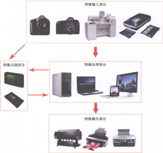
图1-1-1 数字图像处理系统构成
