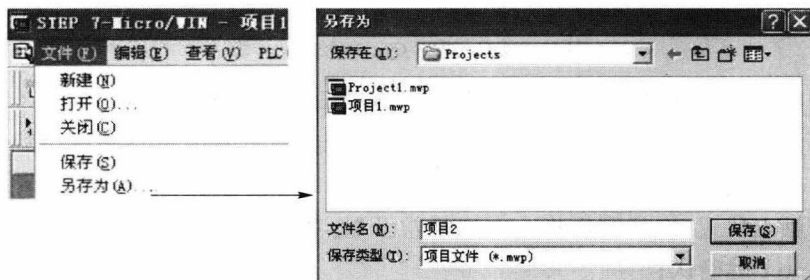
图 1.1.15 存储工程项目
