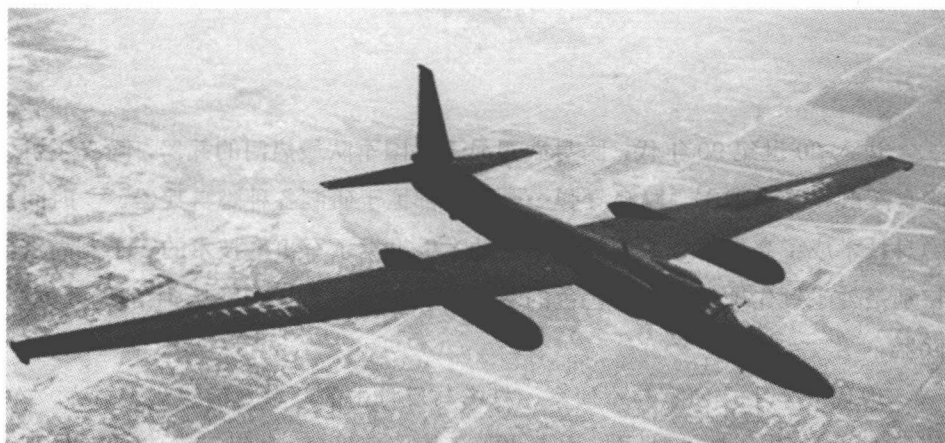
图 1 涂有吸波材料的 U-2 高空侦察机绰号“小龙女”
