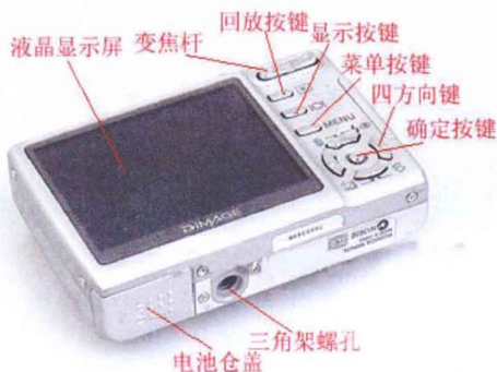
图1-6 佳能某款普通型相机结构示意图
