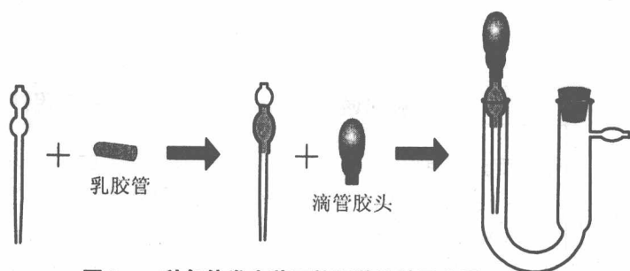
图2 一种气体发生装置的组装连接示意图
