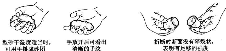
图 1-3 手感法检验型砂
