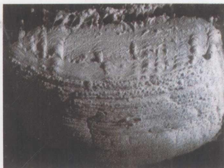
图 6-9 合格防火涂料的发泡层外观
