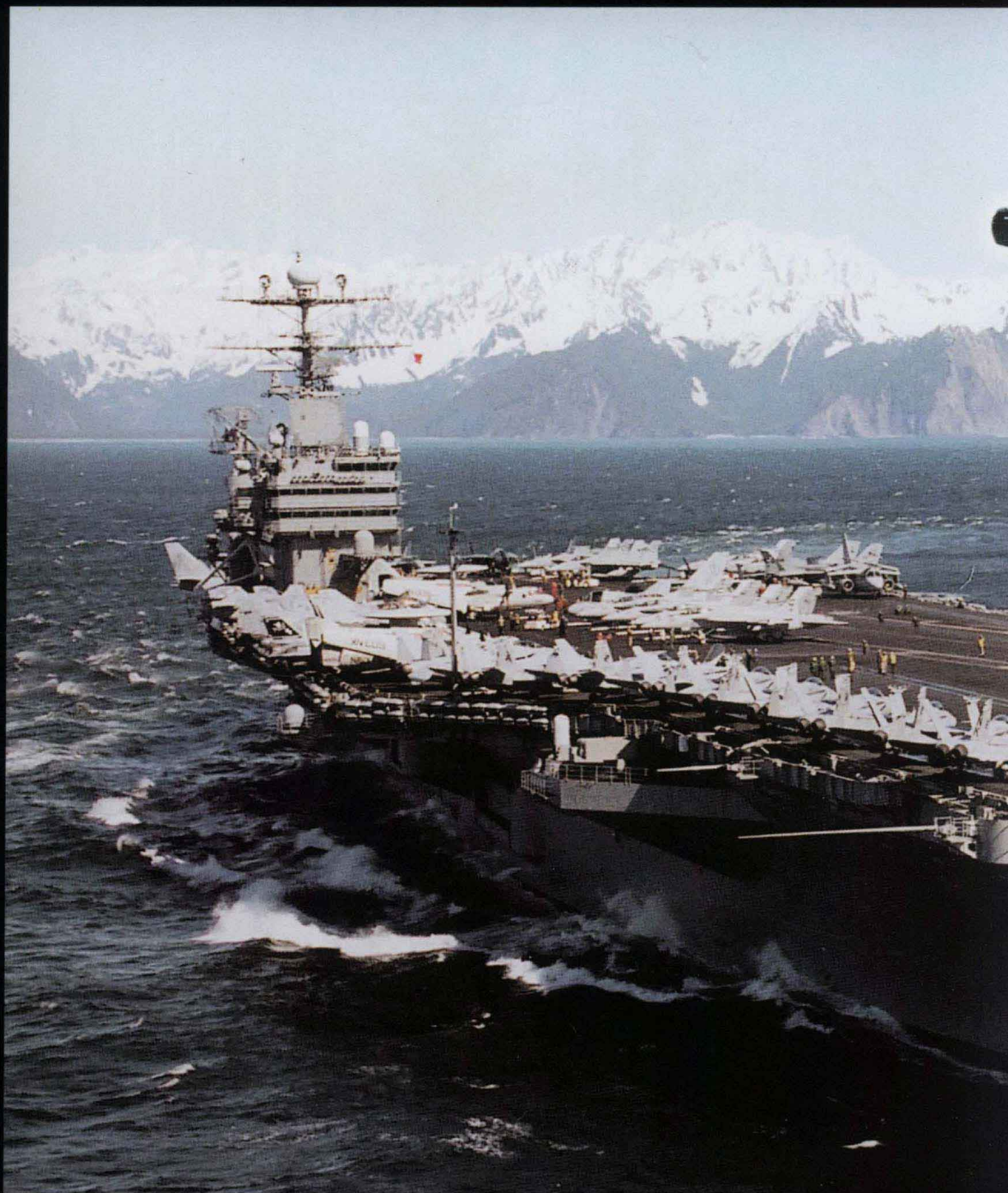
“林肯”号航母，可以搭载 20 架 F-14D，36 架 F/A-18C/E，4 架 EA-6B 电子战飞机，4 架 E-2C 预警机，6 架 S-3B 反潜机等。
