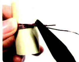
(4) 将竖放在套筒上的铁丝两端拧合起来，与绕圈铁丝的拧合处一起用钳子拧紧。
