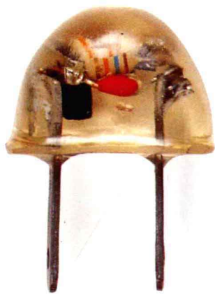
隐蔽的窃听装置 这个展示模型是一个内部隐藏窃听器的插头。
