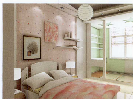
大芯板打底，饰面板饰面，混油
