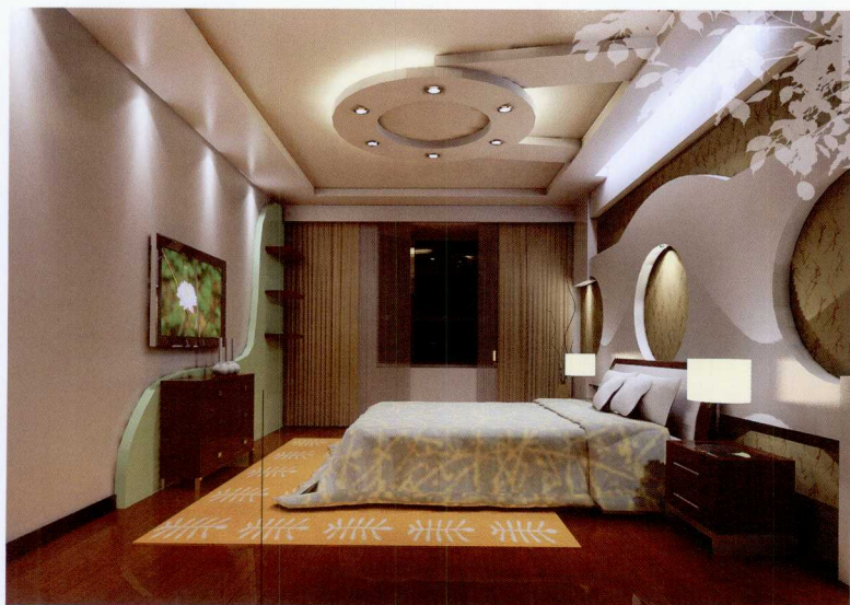
石膏板造型，乳胶漆饰面
