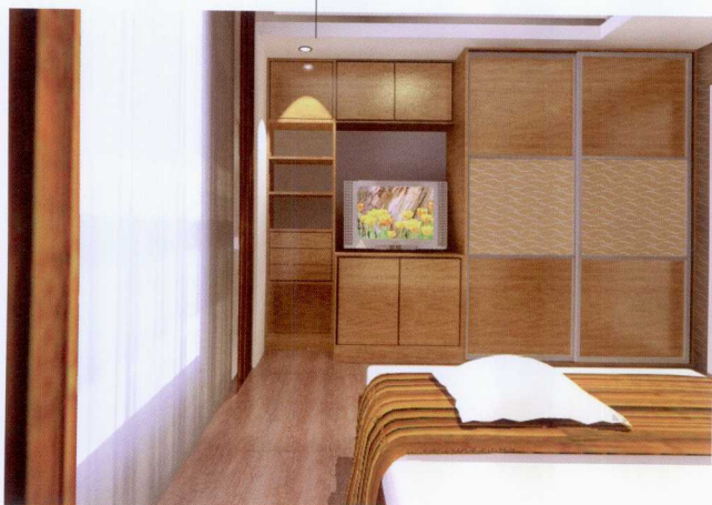
石膏板吊顶，乳胶漆饰面
