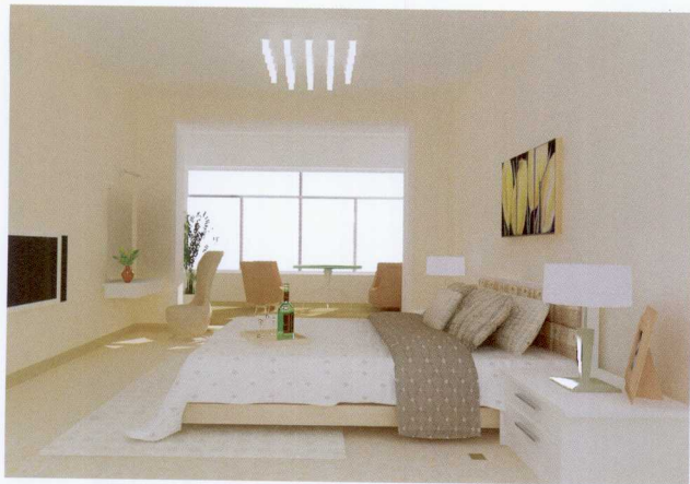
石膏板吊顶，乳胶漆饰面
