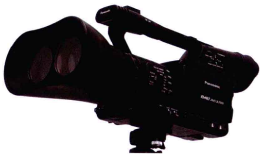
图1-3 能够拍摄立体影像的3D数码摄像机，它具有两个并置的摄影镜头，用于模仿人眼的视角差距。
