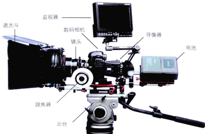
图1-10 装配有高清摄像套件的数码单反相机。其拍摄效果已经可接近电影的水平。
