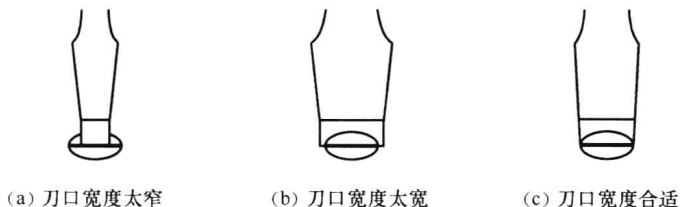
图 1-5 旋具的使用宽度
