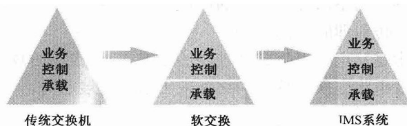
图 1.1 软交换与 IMS 系统的关系
