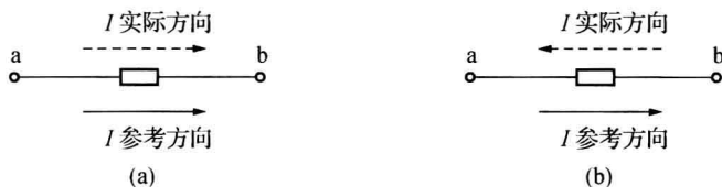
图 1.3 电流参考方向与实际方向的关系
