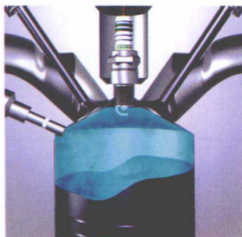
■ 燃油直喷的两种模式图
