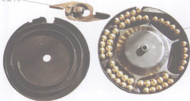
M1928冲锋枪50发弹鼓内部构造
