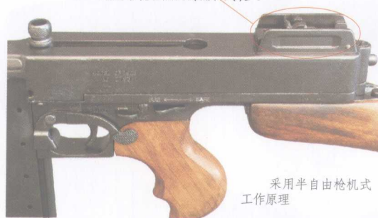
采用带视孔照门的翻转式表尺
