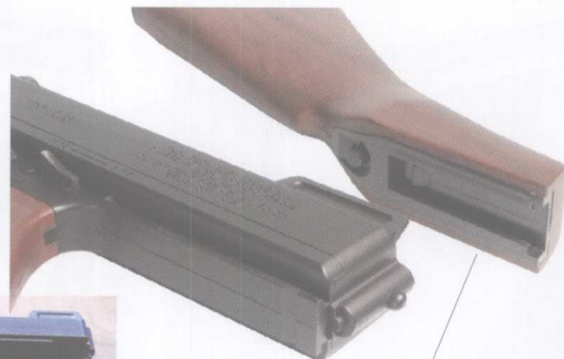
枪托采用可卸式结构
