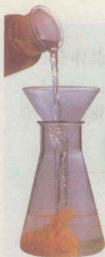
图 1-5 无色透明的硝酸铅和碘化钾反应生成黄色沉淀。
