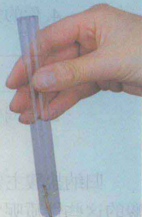
图 1-14 盐酸跟生锈铁钉的反应
