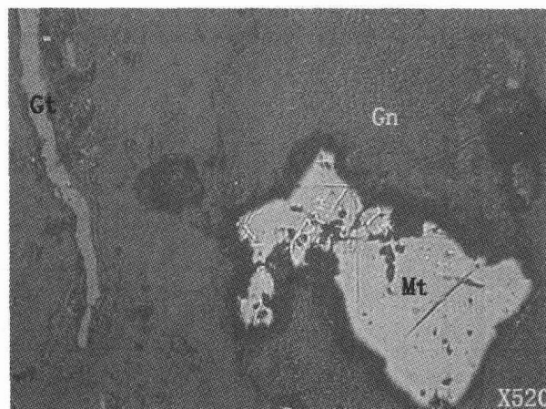
图4 磁铁矿(Mt)和针铁矿(Gt)嵌布在蛇纹石(Gn)基体中 X520
