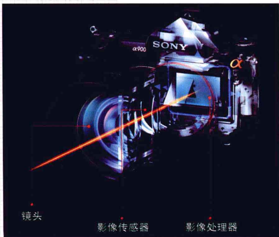
数码单反相机的构成
