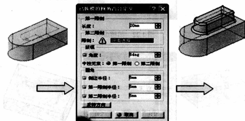
图 1.20 已拔模圆角凸台成形
