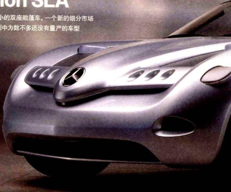
与定位超级概念跑车的Vision SLR相反，Vision SLA定位在比SLK还小的入门级双门跑车，旨在希望更多的人能享受到敞篷跑车的魅力。其中SLA的含义就是在A级车的平台上开发的具有SL跑车特点的紧凑型运动车。它拥有很多Vision SLR的外形元素，采用A级车的底盘和发动机，长度仅有3.77米，比A级车加长了150毫米。A级车是一款5门5座单厢式轿车，而Vision SLA却是一辆双门双座跑车。动力方面，Vision SLA概念车搭载与奔驰A190
