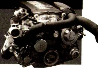
谁说内燃机再无潜力可挖？2007年的法兰克福车展上奔驰F700采用DiesOtto系统的发动机，别看排量仅仅1.8升，最大功率却达到惊人的175千瓦，其性能可媲美3.5升的V6汽油机。这种DiesOtto系统结合汽油机与柴油机的优点，采用可控自动点火系统 (Controlled Auto Ignition)，可在发动机转速落在低速与中速区域时，让DiesOtto以类似柴油机的方式通过高压缩比将汽油压燃。
