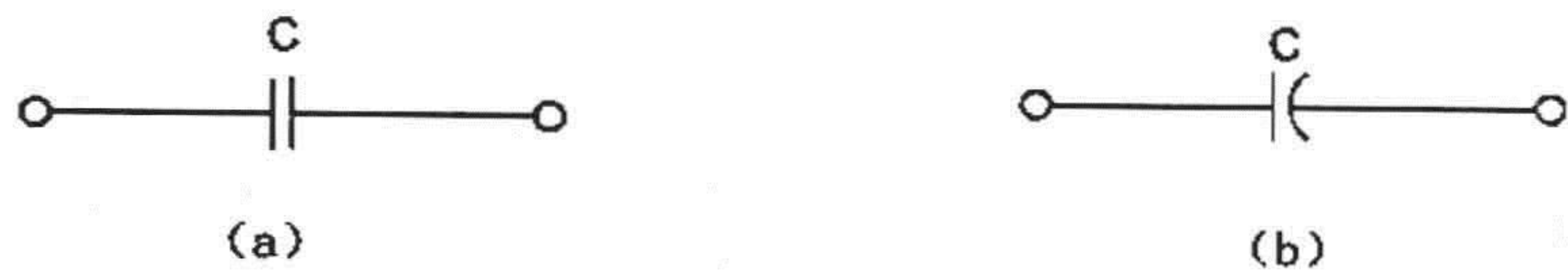
图 1.11 电容的图形符号
