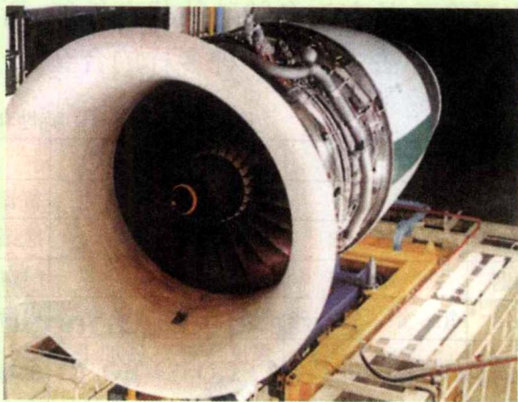
图6-7 用钛合金制造的航空发动机
