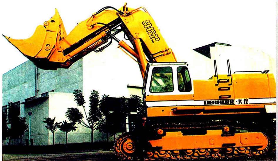
长江挖掘机厂生产的履带式液压挖掘机最大斗容量可达6立方米，为全国之冠
