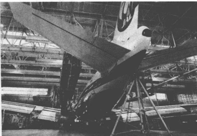
▲ 飞机维修台，用液压机构上下调节
