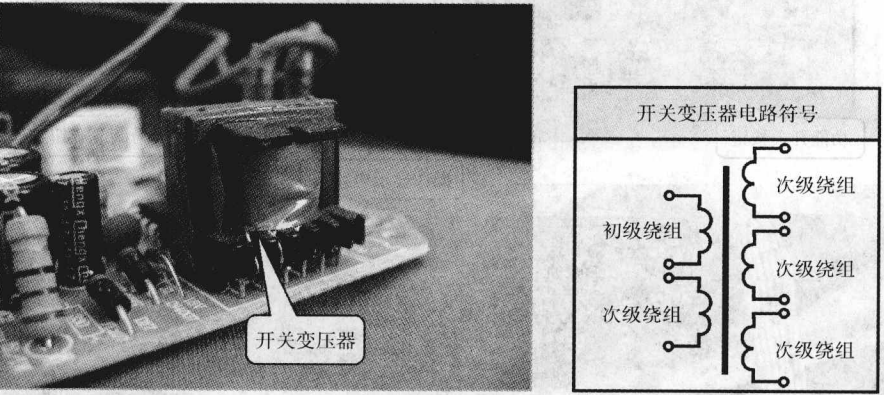
图 1-5 开关变压器的外形结构及电路符号
