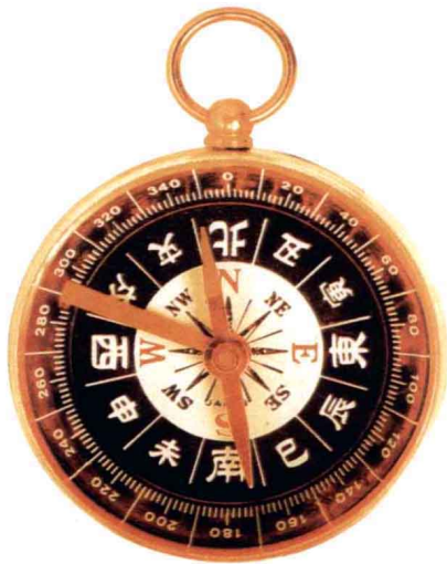
磁铁总有 N 极与 S 极, 这就是指南针的工作原理
