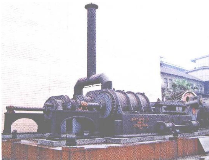
► 图14 原汉阳铁厂轧钢车间8000马力（1马力=735.49瓦）蒸汽机，由英国戴维兄弟公司（Davy Bros Ltd. Engineers）1905年制造。现存于重庆钢铁厂（方一兵摄，2009）
