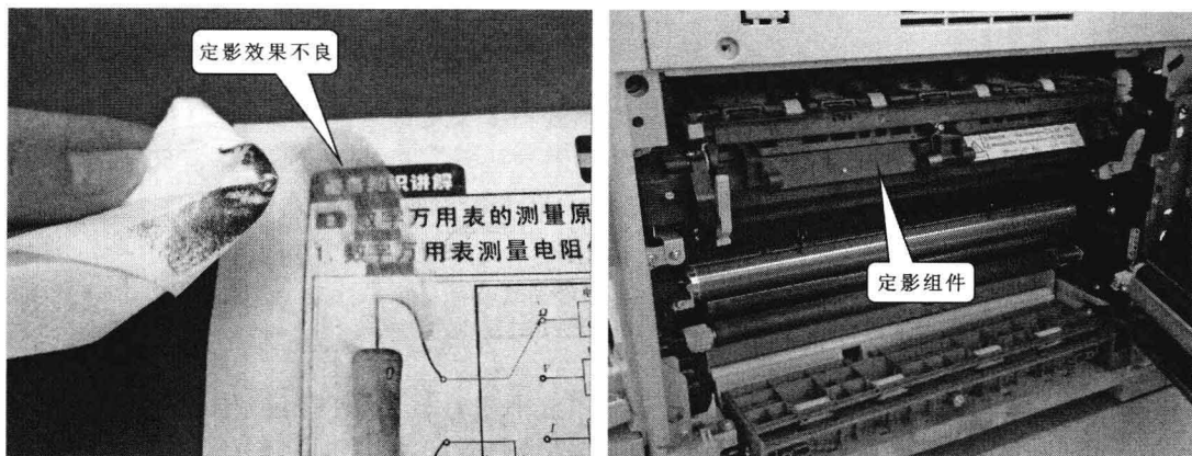
图 1-2 根据定影异常故障，检查定影组件
