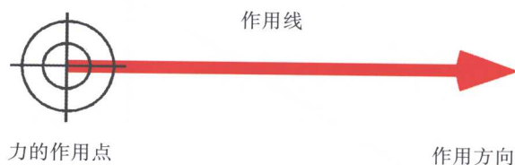
图 1-4 力的矢量特点，包括力的大小、作用线、作用点以及力作用的方向
