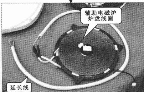
将加工好延长线的辅助炉盘线圈放置到辅助电磁炉上，并将灶台覆盖在上面，引出延长线。
