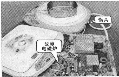
待辅助炉盘线圈与故障电磁炉连接好以后，再将炉面温度检测插入到接口处，检修平台就搭建完成了。
