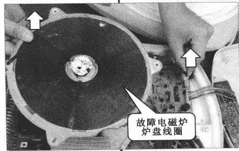
将故障电磁炉外壳拆开，取下炉盘线圈的同时拔下炉盘线圈的传感器。
