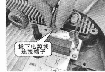
拧下电源供电及功率输出电路板的固定螺钉，该电磁炉的拆卸便完成了。
