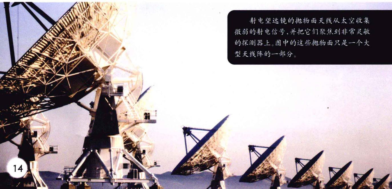
射电望远镜的抛物面天线从太空收集微弱的射电信号，并把它们聚焦到非常灵敏的探测器上。图中的这些抛物面只是一个大型天线阵的一部分。
