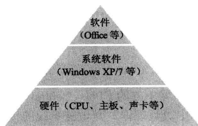
图 1-1 应用软件、系统软件、硬件之间的关系
