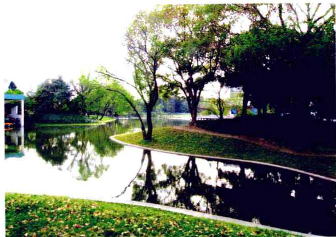
16 垂直式护岸顶部为亲水步道、草坡为疏林的复合式护岸
