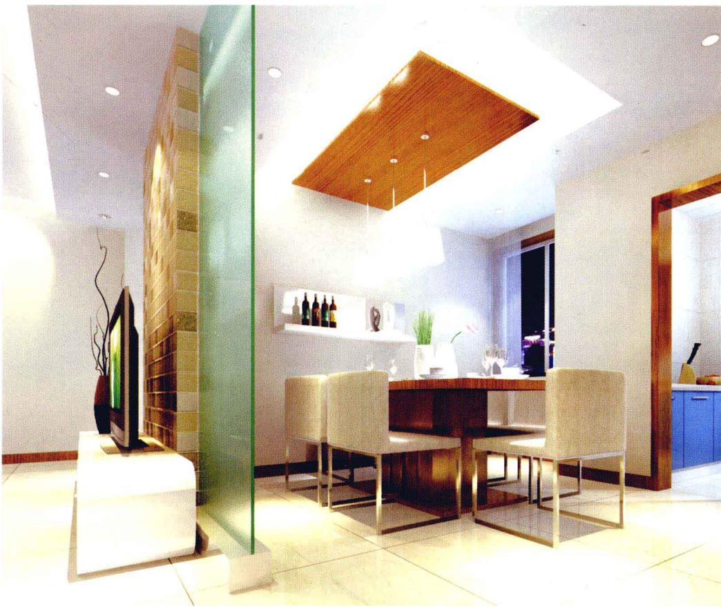
独立的餐厅一般难以形成良好的围合式就餐环境。想要解决这一问题其实不难，在餐厅的顶部做小型的方形吊顶以压低就餐空间，营造围合式就餐气氛；同时将吊顶和吊灯合二为一，由于吊顶的作用，此处可以选择价格便宜的吊灯，但借助吊顶的“气势”，完全可以烘托就餐的主题，并且满足了空间、照明等诸多功能需求。
