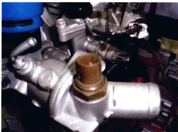
图 1-15 发动机冷却液温度传感器装在节温器上
