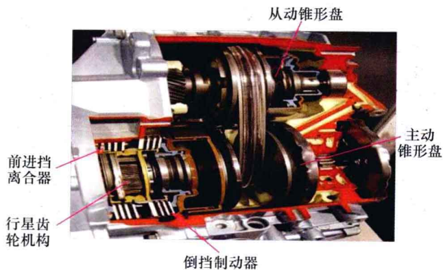
图 1-2 无级变速器
