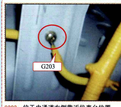
G203: 位于中通道右侧靠近仪表台位置
