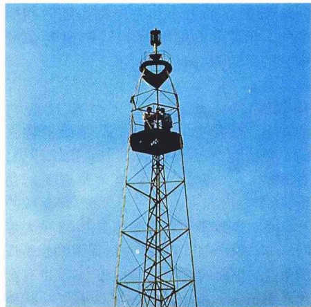
三角测量——在钢标上用光学经纬仪进行角度测量
