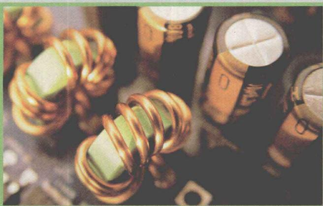
铁磁体在电子学中应用广泛。这里，用铁磁体制成的缠绕着铜线的小珠子被放在计算机的逻辑插件板上。
