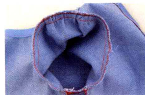
12 缝纫机的针脚改用锯齿缝，把缝份边缘用锯齿缝缝合。
