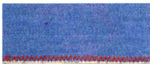
处理好缝份后的样子
