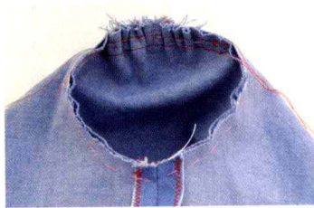
7 在距离记号0.1cm的缝份侧，用疏缝线密密地手缝。
