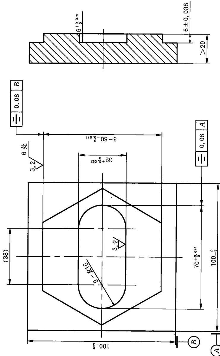
考核要点：基本编程指令和工件装夹，平面、二维轮廓加工和检测。
