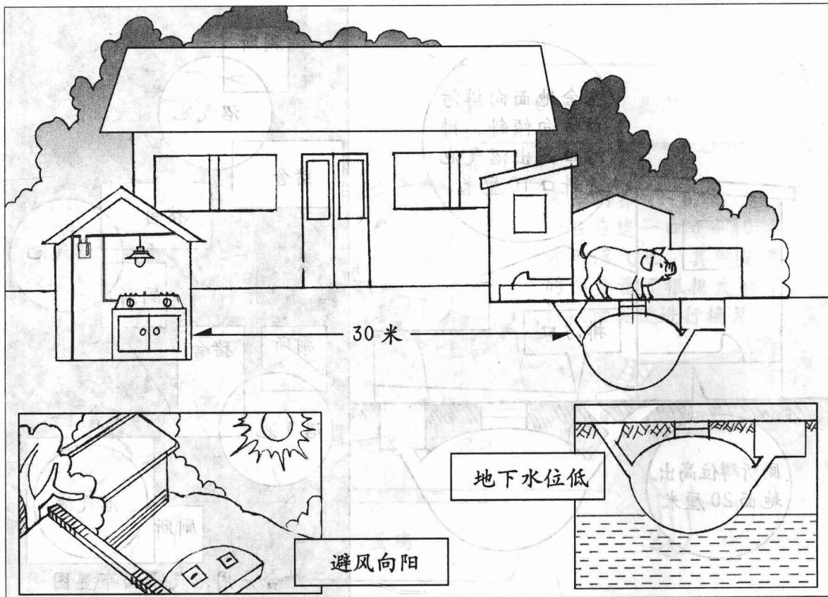
沼气池的地址应选在避风向阳、地下水位低的地方，距离厨房不超过30米。
