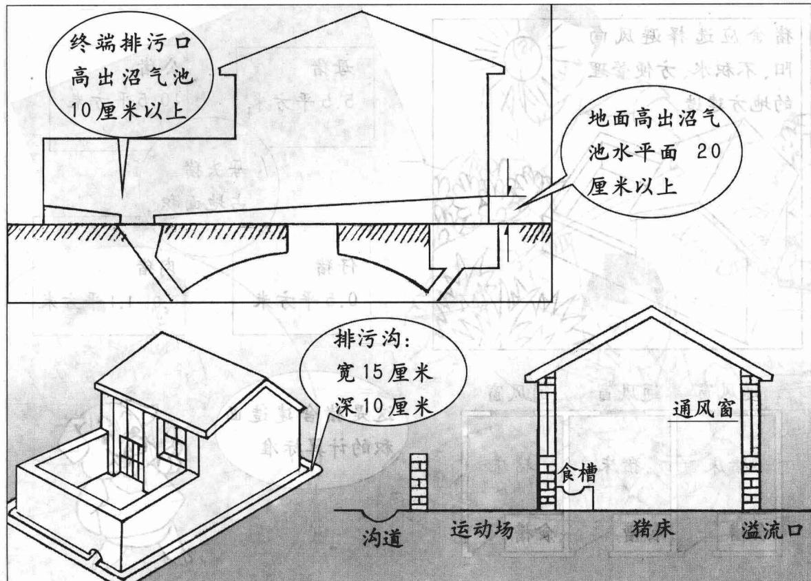
猪舍地面采用混凝土浇筑，水泥砂浆抹平，地面向沼气池进料口方向倾斜。猪舍内外围修建排污沟，向沼气池进料口方向倾斜，以保证畜禽粪便顺利流入沼气池。
