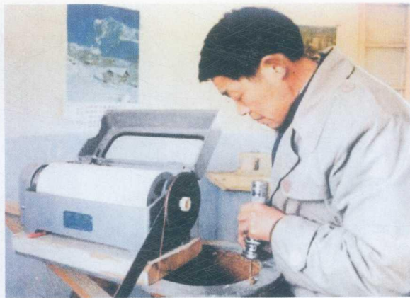
含山县皖 19 井工作人员正在观测地下水位
