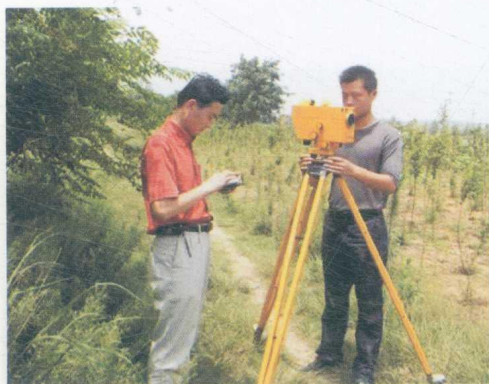
省地震工程研究院技术人员进行精密水准测量
