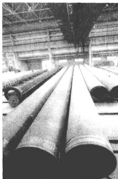
图 1-10 \phi 800\sim\phi 1200\text{mm} 大直径 PHC 桩
